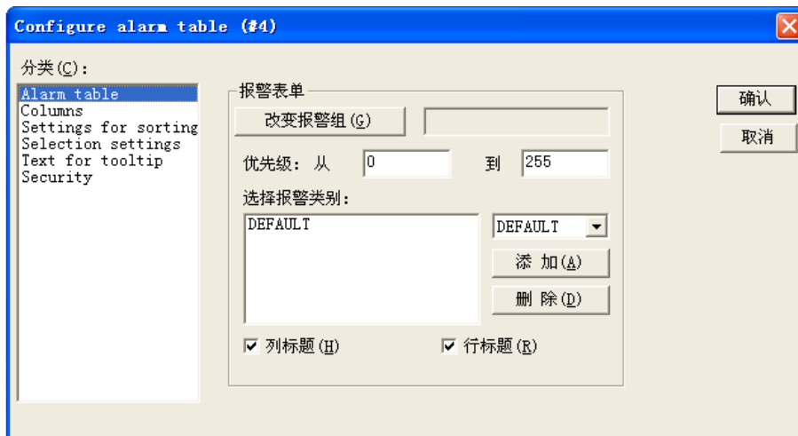
图 11-10-2 报警表配置对话框
