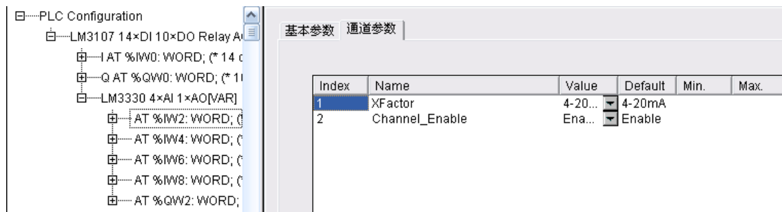
图 10-3-4 设置输入通道的量程
