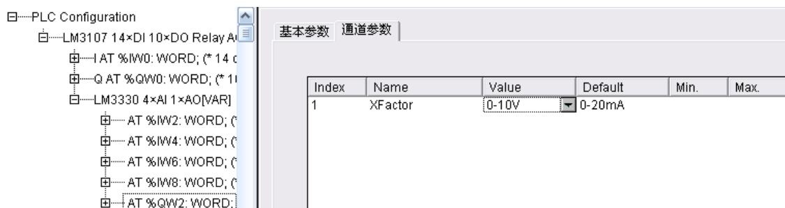
图 10-3-5 设置输出通道的量程
