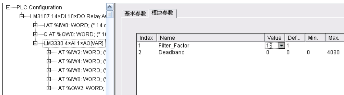
图 10-3-3 设置滤波参数
