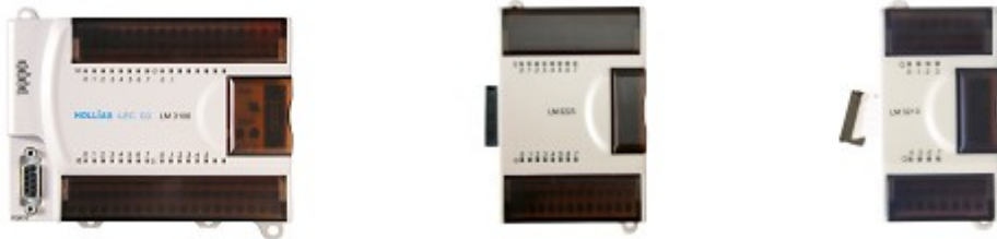
图1.1.1 LM系列小型PLC模块
