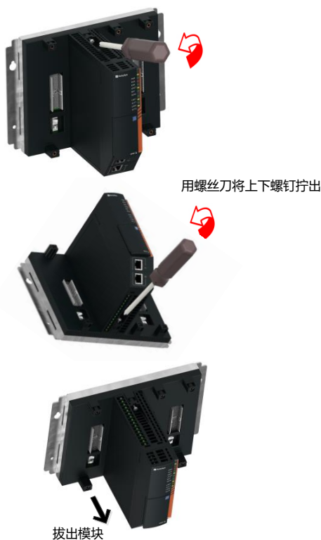
图 12 LKS 模块的拆卸
