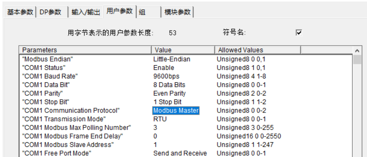
图 228 Modbus 主站参数设置
