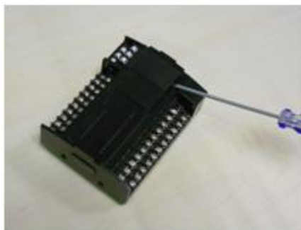
图 100 拆卸盖板示意图
