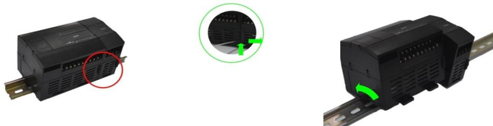
图 162 打开下侧锁示意图
