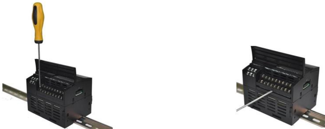
图 168 拆卸端子板连接器示意图
