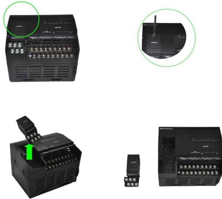
图 167 拆卸功能扩展板示意图
