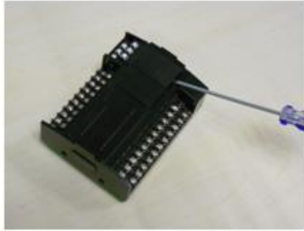
图 90 拆卸盖板示意图
