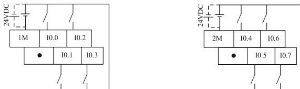
图 107 上排端子定义与接线图
