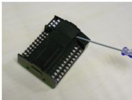
图 96 拆卸盖板示意图
