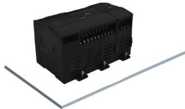
图 157 面板安装方式
