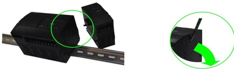
图 163 拆卸连接器盖
