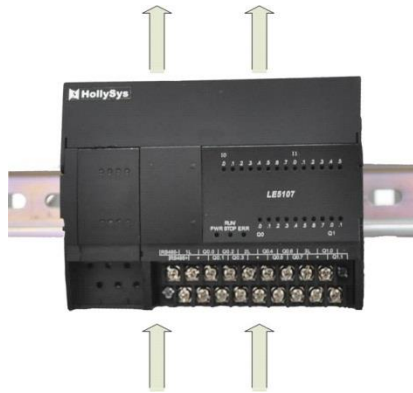
图 156 建议的散热方式图
