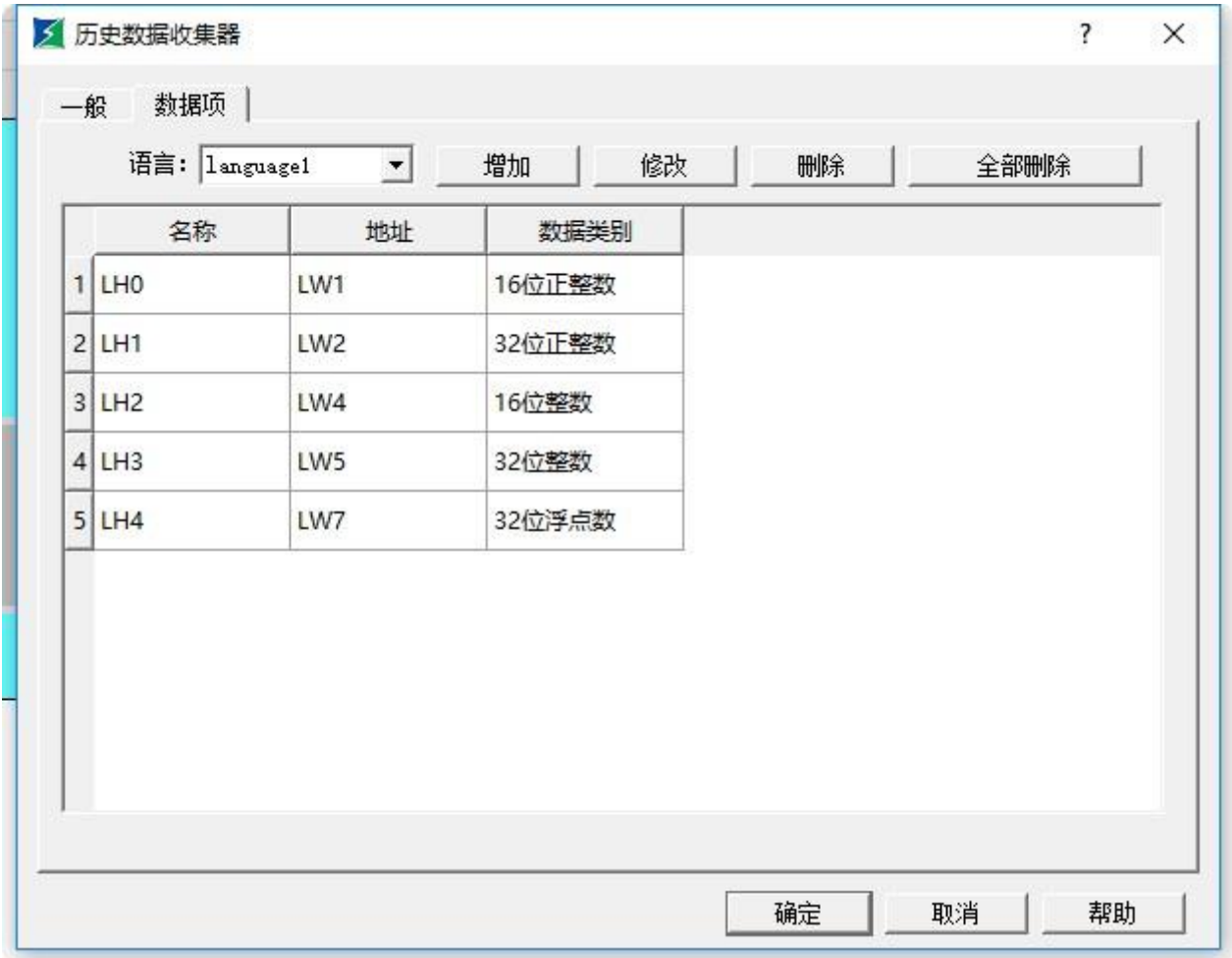
图 5 历史数据显示器“数据”项设置
