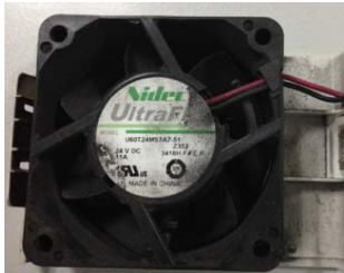
风扇上布满金属粉尘
