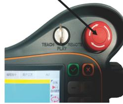
★解除急停后再接通伺服电源时，要解除造成急停的事故后再接通伺服电源。
