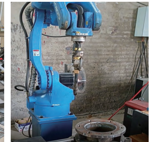
· 电线杆端盖焊接应用
