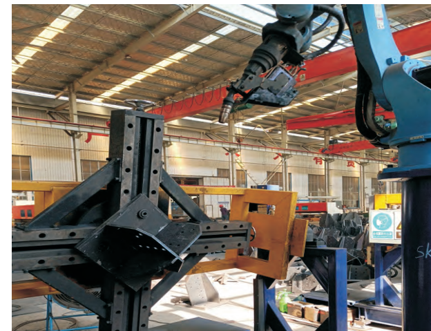
· 铁塔角智能焊接应用
