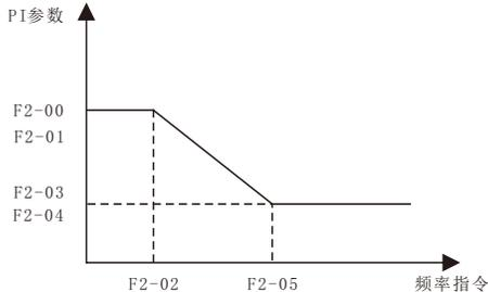
通过设定速度调节器的比例系数和积分时间，可以调节矢量控制的速度动态响应特性。
