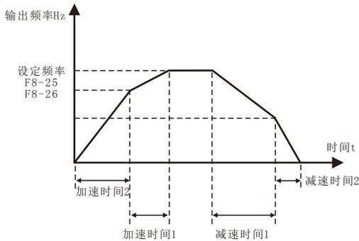
加减速时间切换示意图
