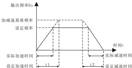
E300提供4组加减速时间，用户可利用数字量输入端子X切换选择，四组加减速时间通过如下功能码设置：
