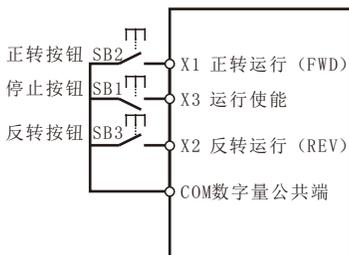
在需要运行时，须先闭合使能端子X3，由X1或X2的脉冲上升沿来实现电机的正转或反转控制。
