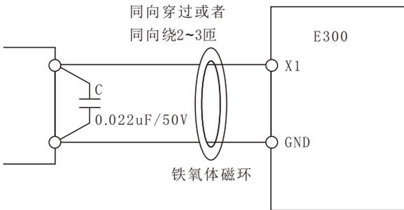
模拟量输入端子处理接线示意图
