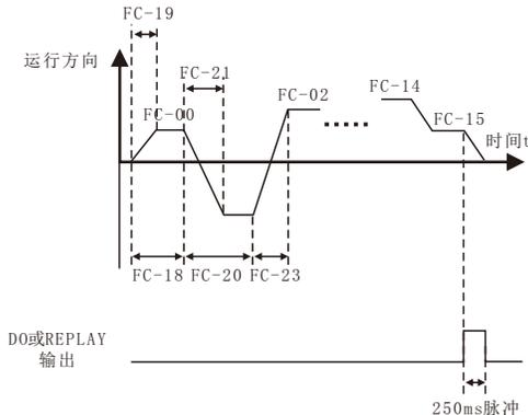
作为频率源时，PLC有三种运行方式，作为V、F分离电压源时不具有这三种方式。其中：
