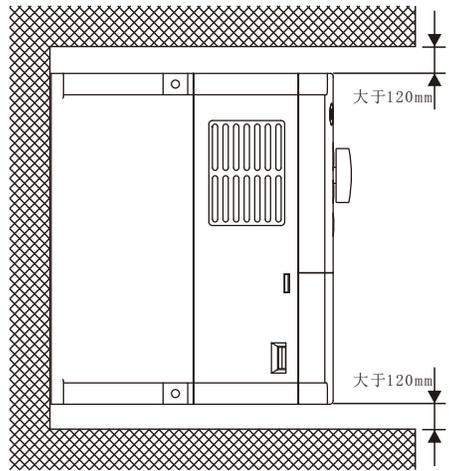
单体安装时：当变频器功率不大于7.5kW时A尺寸可为50mm左右，当大于11kW时A应该大于150mm，因其上下方向为风道，故该空间距离更应加大。
