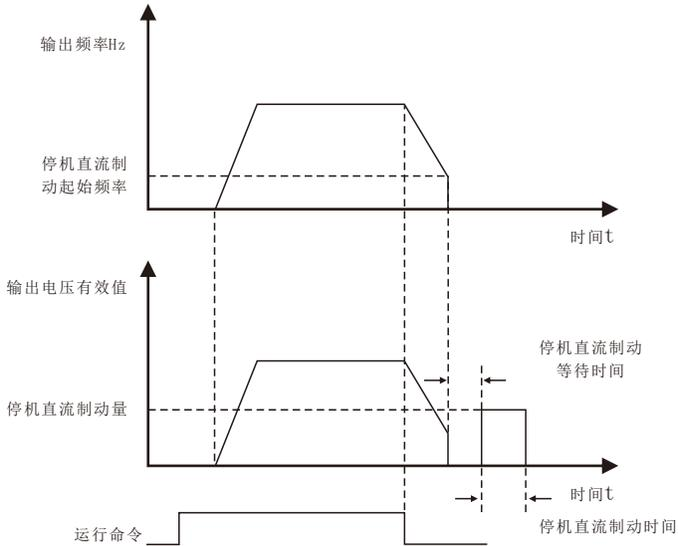
停机直流制动示意图
