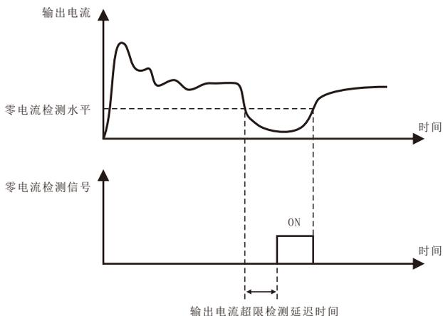
零电流检测示意图
