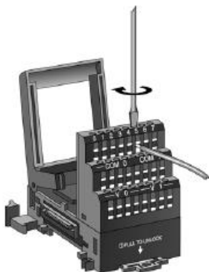
使用螺钉夹具的接线端子
