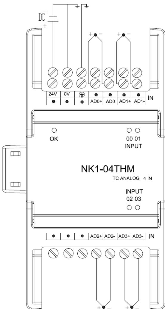
NK1-04THM 扩展单元采用可拆卸式接线端子台，每个扩展单元有 4 个 7P 端子台组用于用户现场接线。你可以轻轻地用一把合适规格的一字螺丝刀插入端子台组上的拆卸孔，从扩展单元上撬开并取下端子台组，这使得用户现场接线、产品维护更加方便。（端子台组的具体装卸方法，请参考《NK1 用户手册》上有关的章节内容。）
