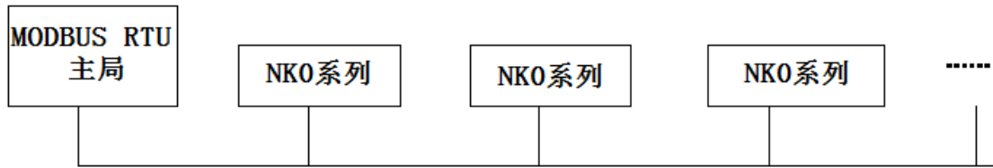
RS-485 MODBUS RTU 协议 最大 247 台（需要时加信号放大器）
