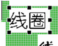
编辑操作是对所选择的部品进行的，通过鼠标点击来选择某个部品，被选中的部品四周圈以 8 个小黑块，以示区分。需要选择多个部品时，可以通过鼠标选定矩形框的方式来选择，或按住[CTRL]键的同时，点击鼠标选择。
