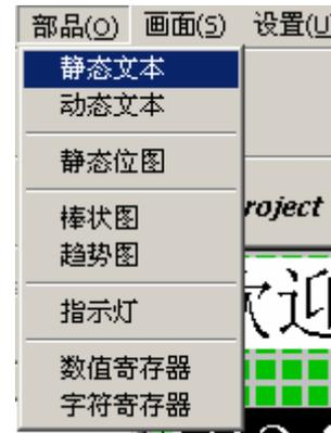
部品的位置可以任意改变，用鼠标选中部品后，按住鼠标左键，光标会变成交叉双箭头形式，把部品移动到合适的位置，放开鼠标左键，即完成一次移动操作。被移动的部品自动对齐到栅格位置。
