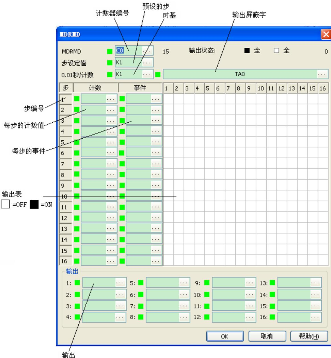
MDRMD 指令有 16 步和 16 个输出，每步的凸轮输出同一个输出屏蔽字位逻辑与。输出屏蔽字区域指定了 16 个输出屏蔽字的首个屏蔽字地址。基于时间和/或事件进行步转移，外部事件输入发生 OFF→ON 的转换时也会发生步转移。步转移的时间在每步的计数值中设定，事件为开关型触点。不使用的步和事件必须空着（缺省状态）。当启动输入为 ON 时，凸轮定时器被启用。只要当前步的事件为 ON，则当前步的定时器开始计时。当步计数值等于步的设定计数值时，凸轮转移到下一步。当最后一步完成或重置输入为 ON 时，此过程停止。CPU 在编程→运行的模式转换后或是重置输入为 ON 时，凸轮进入预设定的步。
