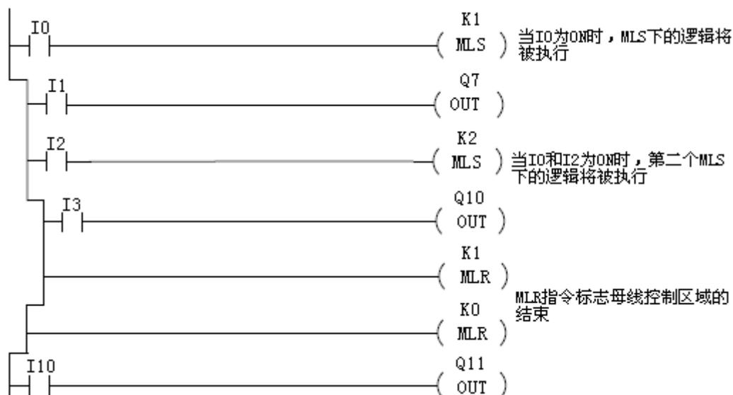
下面的例子中，当 I0 为 ON 时，第 1 个 MLS K1 (A) 和 MLR K0 (B) 之间的逻辑程序才能接通。（注意，如果 I0 为 OFF，程序仍被扫描，但是没有接通。）当 I10 和 I0 为 ON 时，MLS K2 (C) 和 MLR K1 (D) 之间的逻辑程序将接通。最后一行程序不受任何 MLS 线圈控制。
