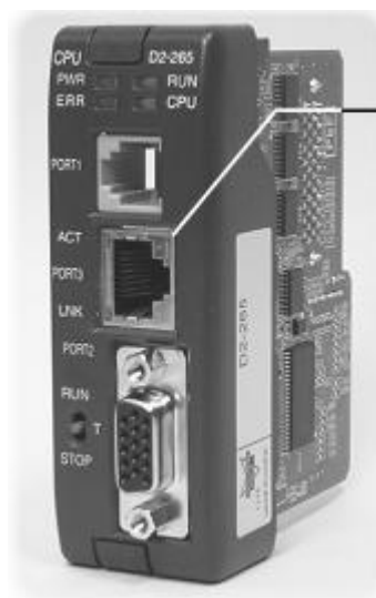
通讯口 3：以太网 /FL-net 通讯的 RJ-45 接 口
