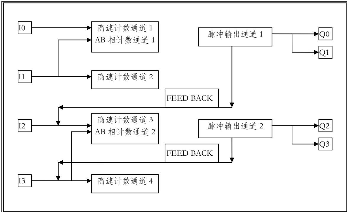
如上图所示：AB 相高速计数需占用 2 个输入点，脉冲输出功能也需占用高速计数通道。所以设定请按照如下原则进行设定：
