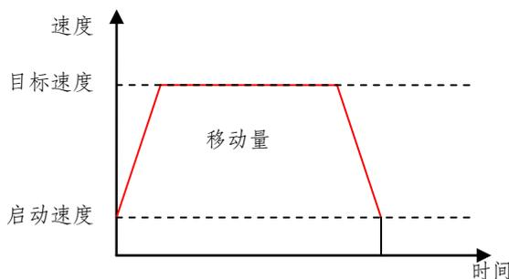
模式 1 中，用户启动定位动作以后，模块按照用户设定进行一次定位动作，其移动位移量数值设置在定位位置寄存器（通道 1：Rn+31，Rn+32；通道 2：Rn+45，Rn+46）中。
