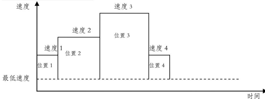
模式 3 中，用户启动定位动作以后，模块按照用户设定的多段速度和位置进行控制，最大可设定 8 段，且 8 段的运行方向相同，其运行方向在第一段位置数据中设置。多段定位动作的段数设置在脉冲输出模式控制寄存器的高位字节中（通道 1：Rn+30；通道 2：Rn+44）。
