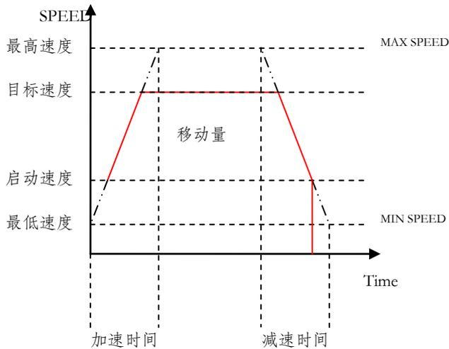
注：本模块的加(减)速时间的设定值受加(减)速变化率的限制，此变化率的计算方法为：
