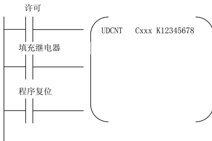
如上图所示，许可继电器上升沿启动高速计数，下降沿停止高速计数，程序复位高电平复位，低电平不复位。
