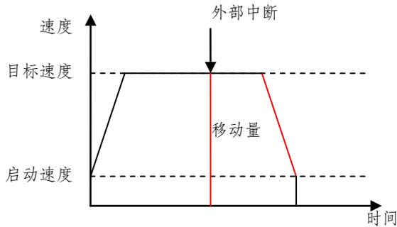
模式 2 中，用户启动定位动作以后，模块按照用户设定进行加速运行直到目标定位速度，后一直按定位速度运行，直到检测到外部中断信号（通道 1 为 I1；通道 2 为 I3）。当外部中断信号来的时候，模块根据定位位置寄存器（与模式 1 相同）内数值完成定位动作。当指定移动量小于等于减速距离的时候，外部中断输入后直接进行减速，并且报告模式 2 定位位置错误。
