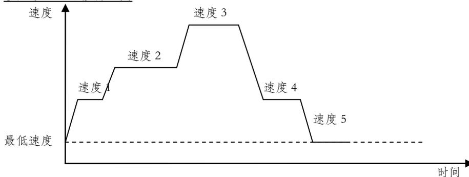
模式 4 中，用户启动定位动作以后，模块即按定位速度寄存器（通道 1：Rn+33，Rn+34；通道 2：Rn+47，Rn+50）中的速度值输出脉冲信号。在定位动作过程中，一旦改变定位速度寄存器的值，模块即按新的速度进行定位动作，而无需重新启动定位。
