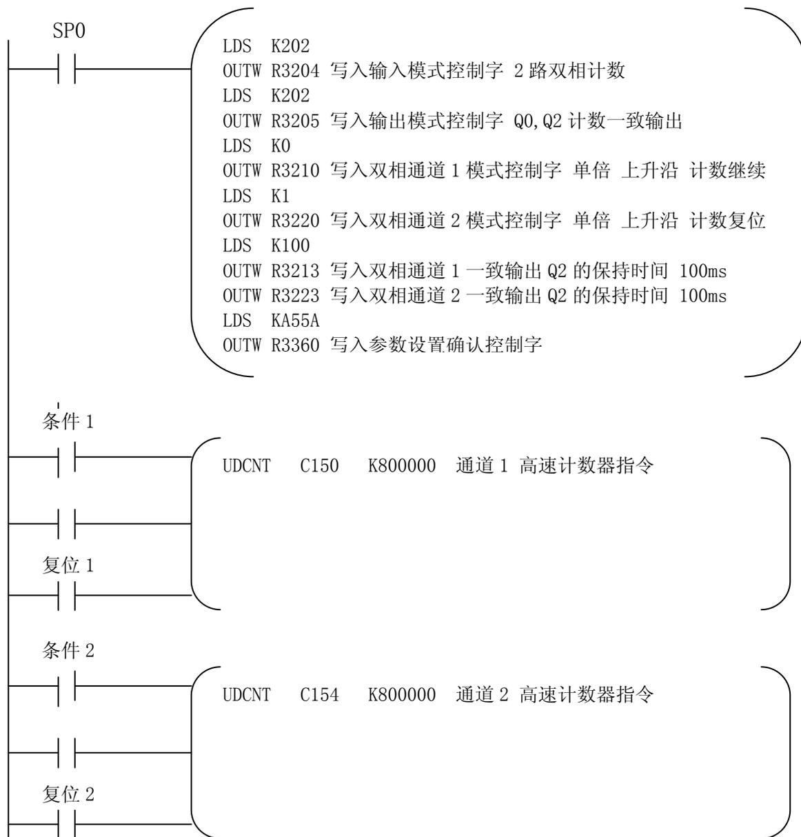
由于 SN 出厂时缺省的初始设置为其模块设定寄存器组使用 R3200 开始的寄存器，所以上面的例子程序中没有写入模块设置寄存器组的设置程序语句段。如果在 D2-250-1, D2-260 等 PLC 上使用本模块时，必须要在本设置程序段前加入模块设置寄存器组的设置程序语句，具体参见下面的脉冲输出例子程序。
