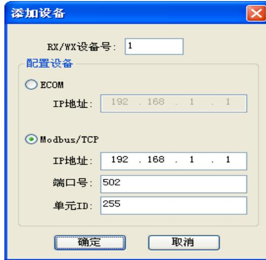
K2-ECOM100模块作为client设备时，可访问多个server设备。PLC的RX/WX命令使用“RX/WX设备号”来区分要访问哪一个server设备。KEW NET EDIT工具软件提供了“点对点配置”的表格(如下图)，来使“RX/WX设备号”和server设备的通信参数对应起来。
