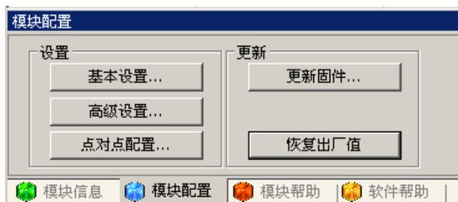
模块配置子画面页用于对选中的 K2-ECOM100 模块进行各种参数设置操作及更新操作。设置操作包括“基本设置”，“高级设置”，“点对点配置”；更新操作包括“更新固件”，“恢复出厂设置值”。
