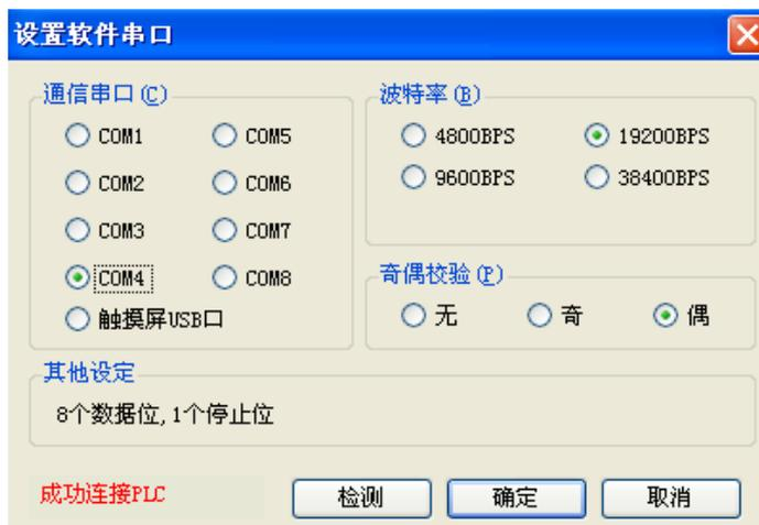
注意：利用“触摸屏 USB 口”下载 PLC 程序时，请使用 USB 连接线连接电脑和触摸屏，再通过串口线连接 PLC 和触摸屏，方可实现下载功能。
