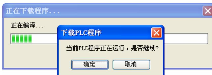
选择“确定”，PLC 将停止运行，下载新程序。下载程序时，弹出进度条。
