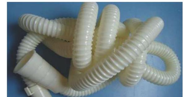
由于软管具有韧性，切点不能每次正好走到切刀下，导致切割的软管不符合工艺要求。X-SIGHT视觉定位系统可补偿切点的偏移，保证切刀切在特征点处。
