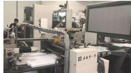
SCARA双相机天地盖贴盒系统主要由双相机、视觉控制器以及SCARA机械手系统组成。
