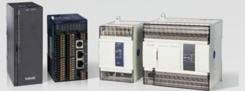
以太网系列 PLC 本体自带 10/100M 自适应的 RJ45 接口，支持 Modbus TCP、X-NET、TCP/IP 自由通信等网口通讯协议，可以与各种网络设备互联，支持多线程通讯，可以与多台设备同时进行多种协议的通讯。以太网模块相比，提升了网口带宽，增强数据通讯的吞吐量；丰富了通讯协议，支持与更多网络设备互联互通；优化了使用方式，方便用户配置和编程。
