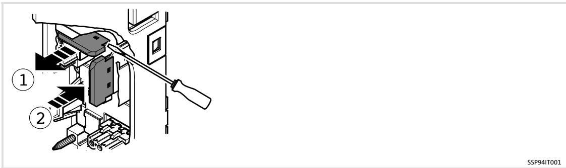
7-8 将IT绝缘帽塞在接地跨接线上
