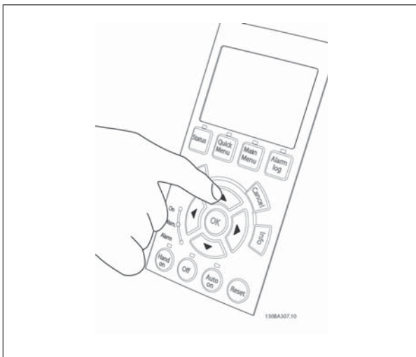
图 5.26: 步骤 6: 电动机的速度可在 LCP 上看到。按向上 (▲) 和向下 (▼) 箭头按钮可以调整速度。
