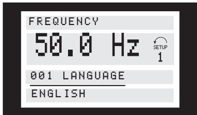
显示器的第 3 行显示参数代码和名称，第 4 行显示所选参数的状态/值。
