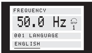
显示器上最底端一行显示当以 [OK]（确认）键确认时将输入（保存）的文本值。
