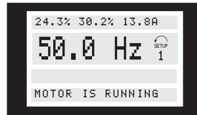
在该状态下, 同时显示四个运行值的数据值, 这些值带有 cf. 表中的相关单位。例如, 在第 1 行和第 2 行中选择参照值、转矩、电流和频率作为变量。
