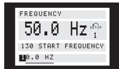
所选数字将闪烁。显示器上最底端一行显示当以 [OK]（确认）键退出时将输入（保存）的数据值。
