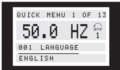
在显示器底部显示参数代码和名称，以及快捷设置下第一个参数的状态/值。接通该单元后首次
