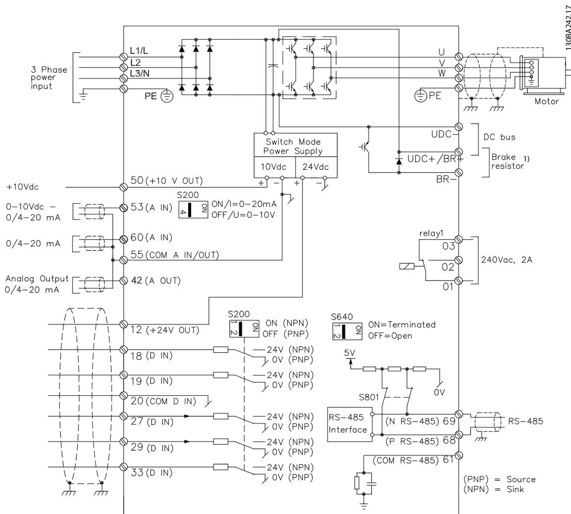
图 1.6 图中显示了所有电气端子
