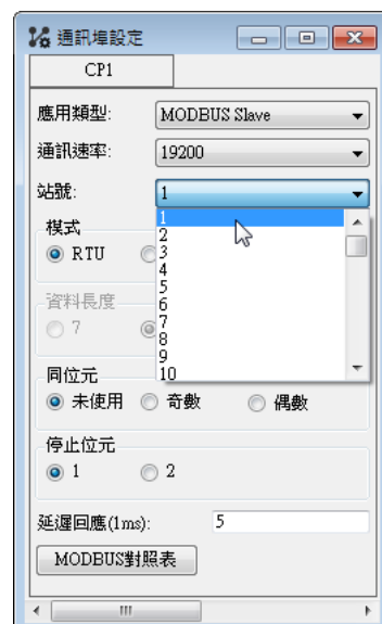
站号设定为1号站
