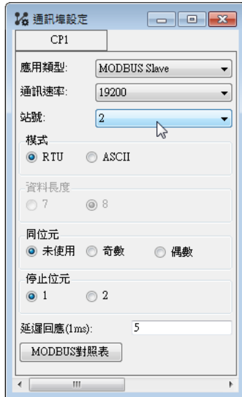
站号设定为2号站
