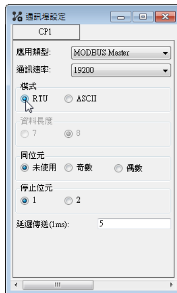
设定主站 PLC 的 相关通讯参数
