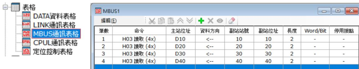
4. 此范例使用本卡 CH2 (PLC 的 CP3) 進行對網路 Modbus TCP 從站的資料讀取與寫入，下方的 RS-485 也可當作主站，經由串列傳輸對其它從站進行 Modbus RTU 通訊。（※注意事項 #4）
