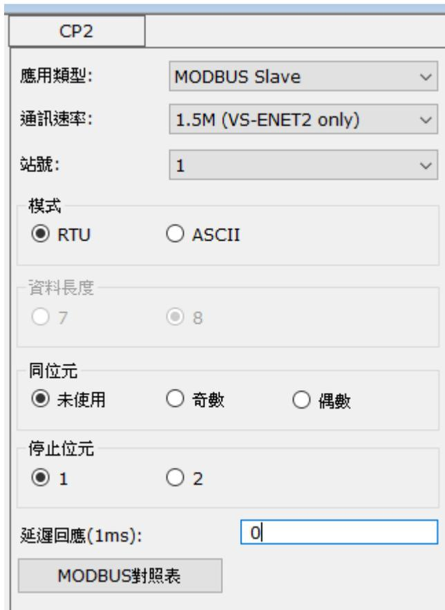
3. 使用 Modbus TCP 或 UDP Client 之主站 ( PLC / 模擬軟體 / 圖控軟體 / 人機介面 )，可經由網路 IP 連 VS-ENET2-EC，本模式之 Port#502 會自動將 Modbus TCP 之命令轉為 Modbus RTU 串列通訊送給 PLC 之 CP2，以對 PLC 進行元件資料的讀取與寫入。( 對應 PLC 之元件編號可如上图在編輯 PLC 通訊口設定下，開啟 [ MODBUS 對照表 ]。 )
