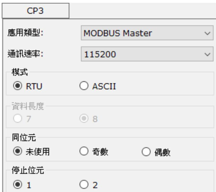
3. 點選 [ 專案 ] — [ 表格 ] — [ MBUS 通訊表格 ]，建立一個 Modbus 通訊表格並在程序中使用 MBUS 指令，再以 Mini USB 線載入專案到 PLC。
