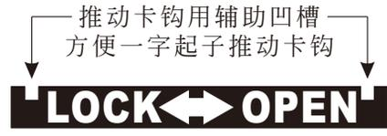
卡钩向左侧移动，可将扩充卡固定在主机上。
