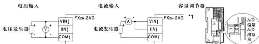
\*1如果安装在FX2N-2AD上的容量调节器转向右边时(顺时针), 数字值增加。
