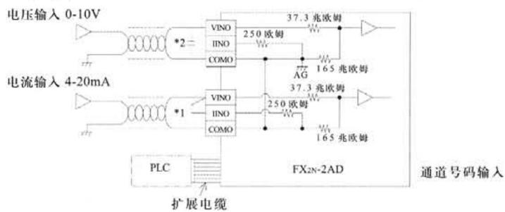
\*1 FX<sub>2N</sub>-2AD 不能将一个通道作为模拟电压输入而将另一个作为电流输入，这是因为两个通道使用相同的偏值量和增益值。
