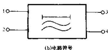
图 4-352 色度延迟线的结构和电路符号
