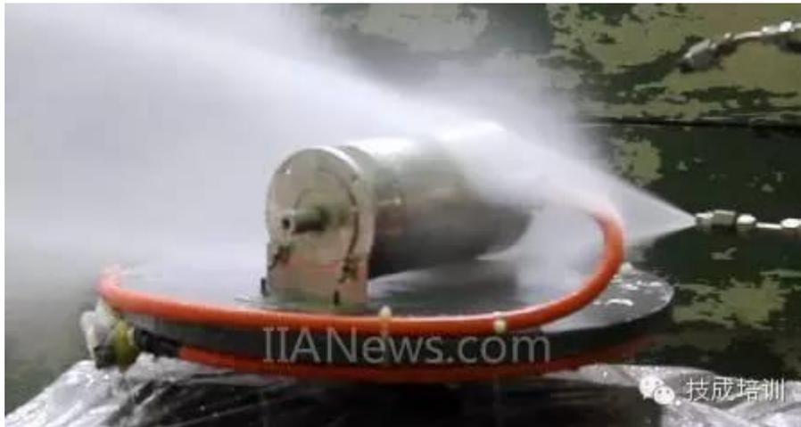
3、IP69K 电机是适用于严苛冲洗环境的优选方案，因为该评级意味着电机可以耐受高达 1450 PSI 的水流，这些电机大多采用不锈钢外壳，因为油漆在这种条件下无法长久保持。此外，其中的 K 表示所使用水流的温度可以高达 80° C。
