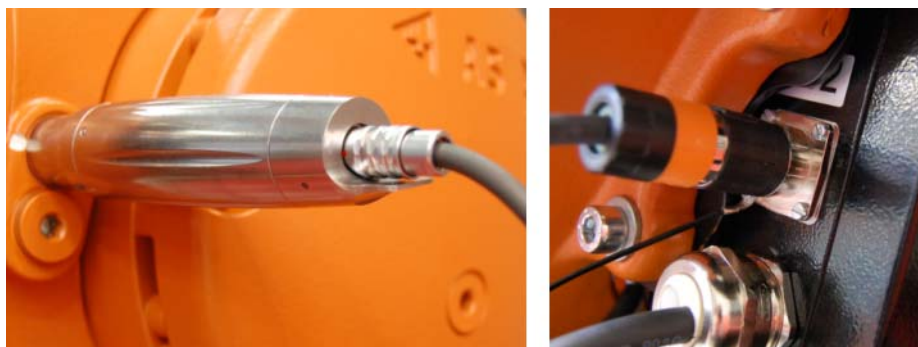
图 3-8: EMD 电缆，连接
