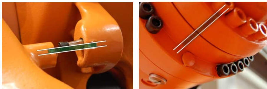
图 3-6: 预零点标定位置示例
