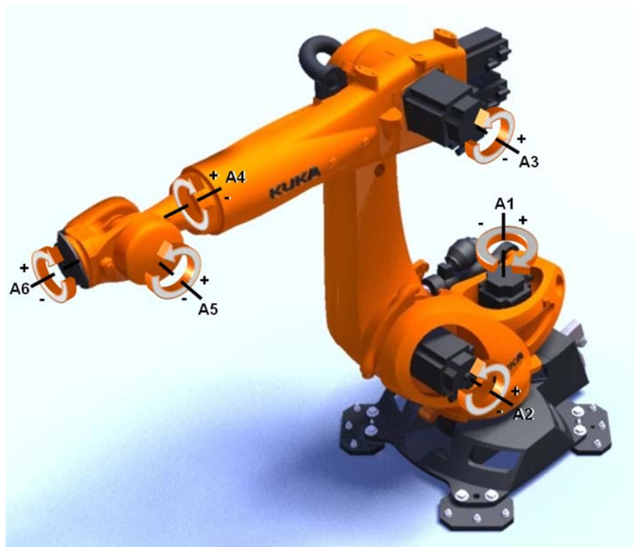
图 1-4: 库卡机器人自由度
