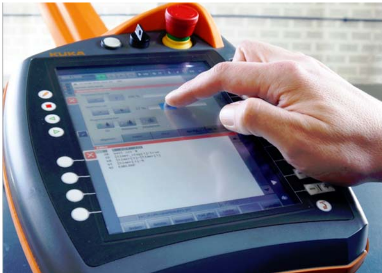
图 1-10: 可利用库卡 smartPAD 进行机器人编程
