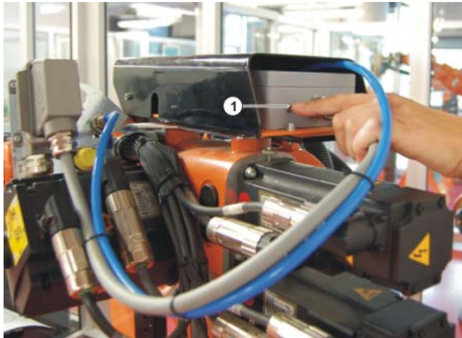
图 3-24: 碰撞保险装置的撤回开关
