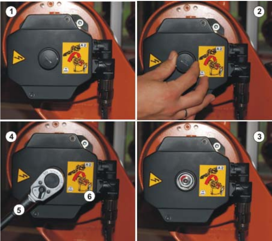
图 2-5: 使用自由旋转装置的操作步骤
