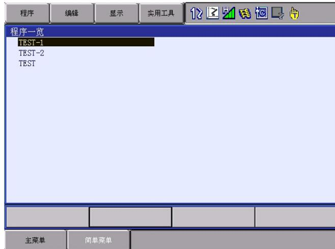
2. 将光标向希望复制源程序移动。
