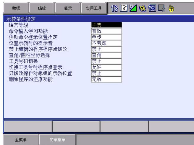
3. 将光标移动到“禁止编辑程序的程序点更改”，按“选择”。
