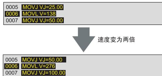
并且在速度修改的操作上，即可修改对象程序所有区间的速度，也可修改指定区间的速度。
