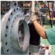
2、紧固电机之前要确认电机是否水平，无缝隙，并按拧紧规定用力矩紧固
