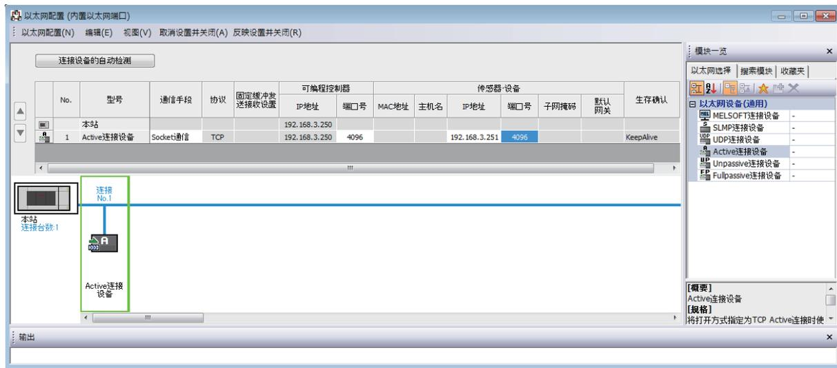
• 将“模块一览”的“Active连接设备”拖放到画面左侧，并进行如下设置。
