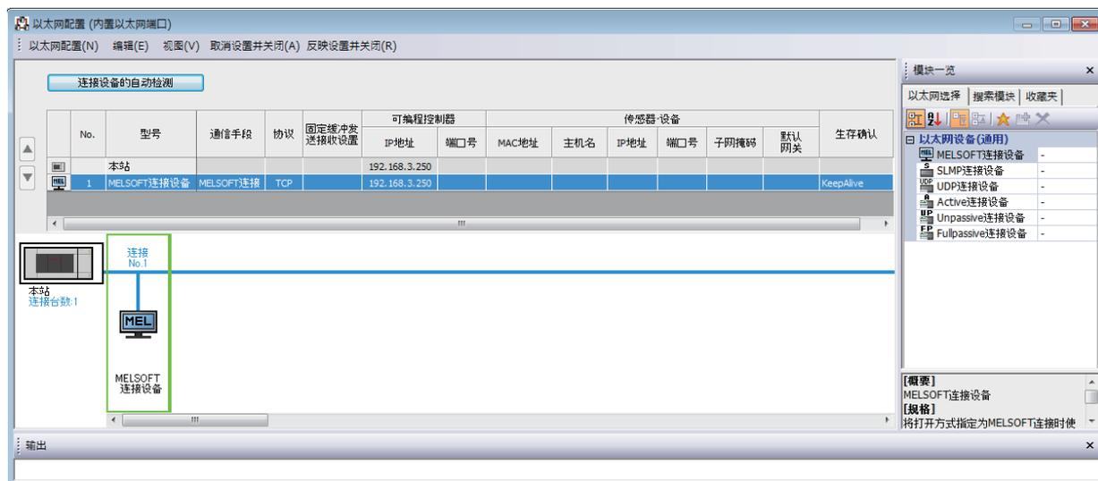
将“模块一览”的“MELSOFT连接设备”拖放到画面左侧。在“协议”中选择适合对方设备的协议。
