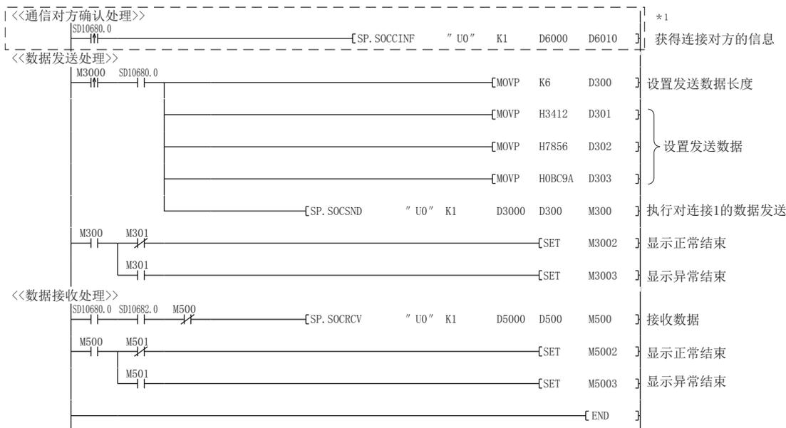
\*1 要获取TCP连接的对方设备的信息时，应执行虚线内的程序。
