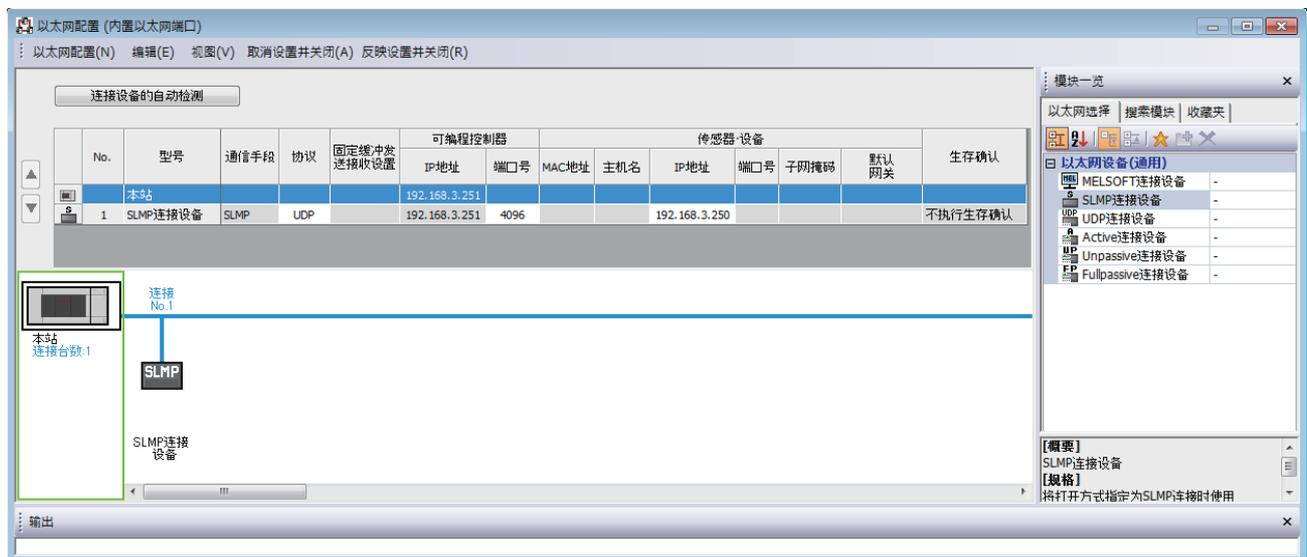
4. 将已设置的参数写入到CPU模块中后，复位CPU模块，或将电源置为OFF→ON。
