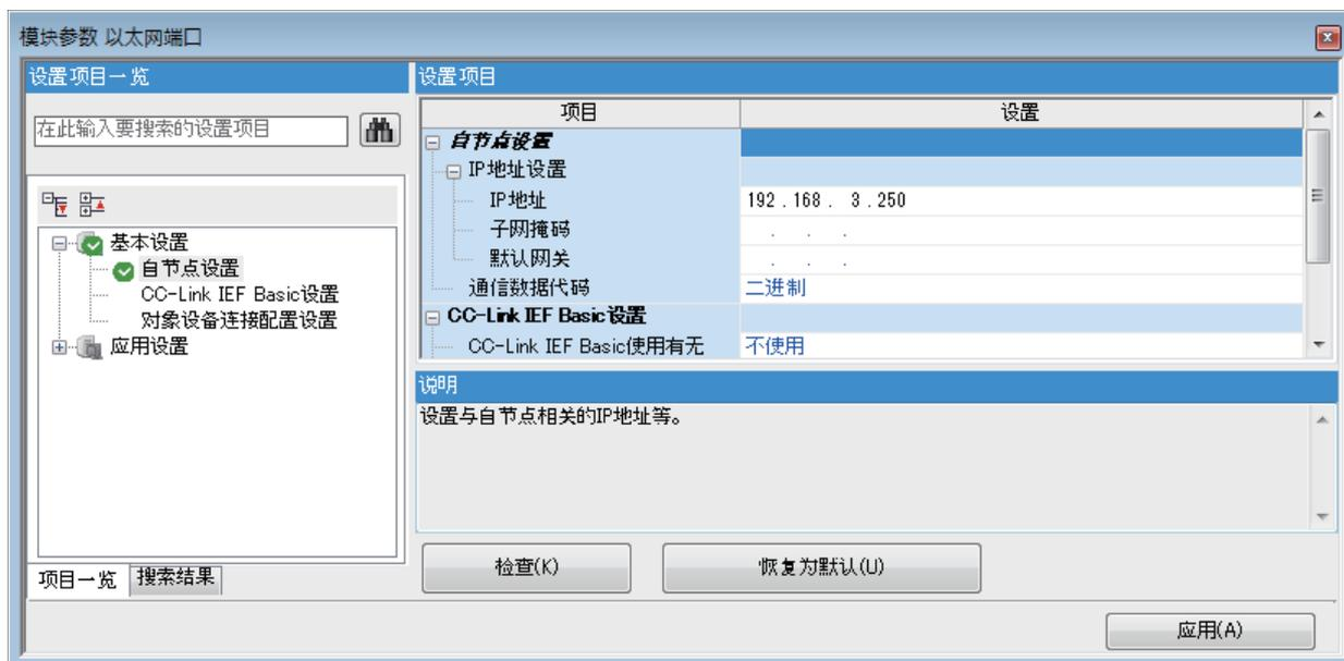
1. 在自节点设置中进行“IP地址设置”、“通信数据代码”设置。
