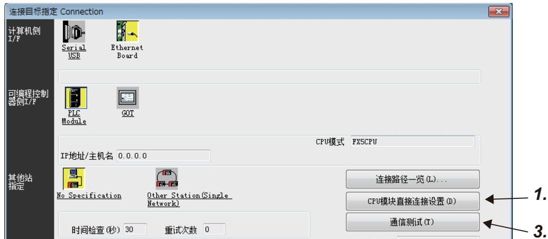
1. 在“连接目标指定 Connection”画面中，点击[CPU模块直接连接设置]按钮。
