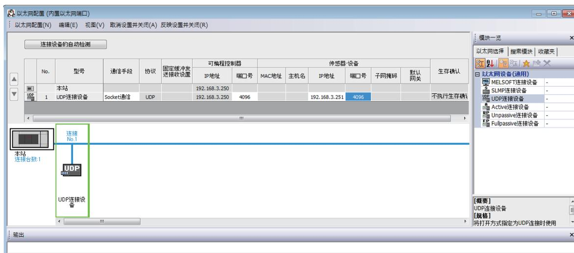
• 将“模块一览”的“UDP连接设备”拖放到画面左侧，并进行如下设置。
