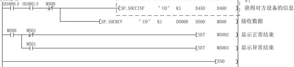
\*1 要获取UDP连接的对方设备的信息时，应执行虚线内的程序。
