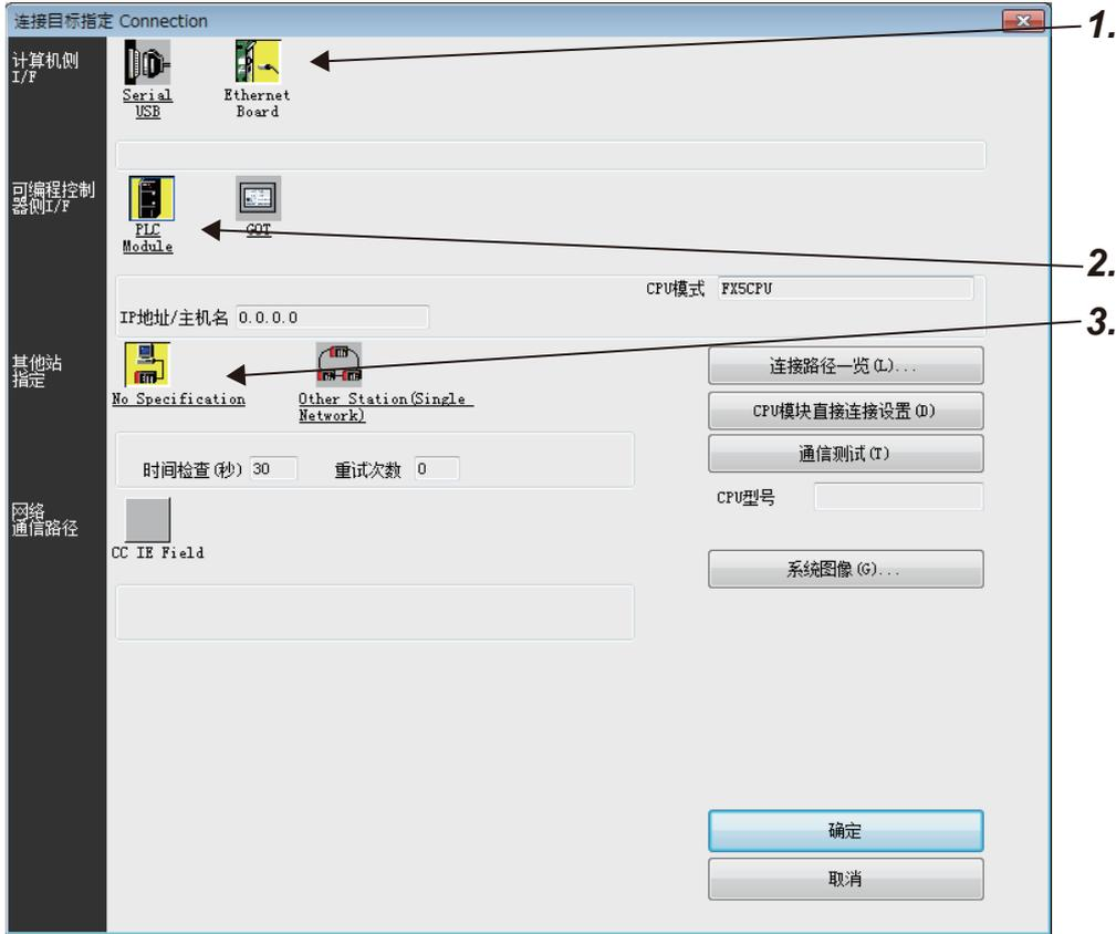
1. 将计算机侧I/F设置为“Ethernet Board”。
