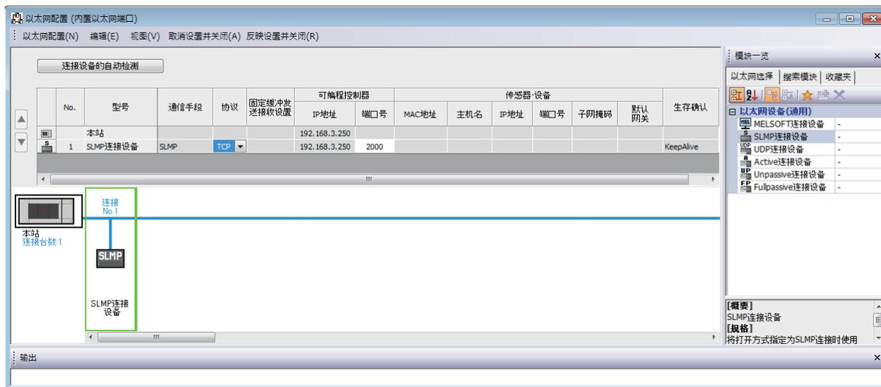
3. 将“模块一览”的“SLMP连接设备”拖放到画面左侧。在“协议”中选择适合对方设备的协议(TCP或UDP)。在“端口号”中设置本站端口号 (设置范围: 1025~4999、5010~65534)。此外, 5000~5009已被系统使用, 请勿指定。
