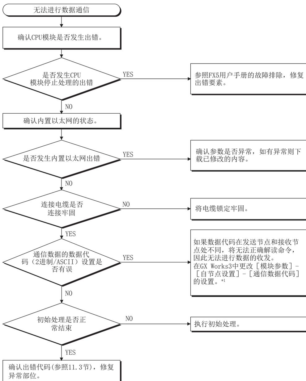
\*1 内置以太网的通信数据代码设置与对方设备的数据代码设置不同时，出错代码一览中没有的出错代码有可能会被返回至对方设备侧。内置以太网接收到数据代码不同的数据时，无法正常解读命令。内置以太网会按照通信数据代码设置，返回出错响应。
