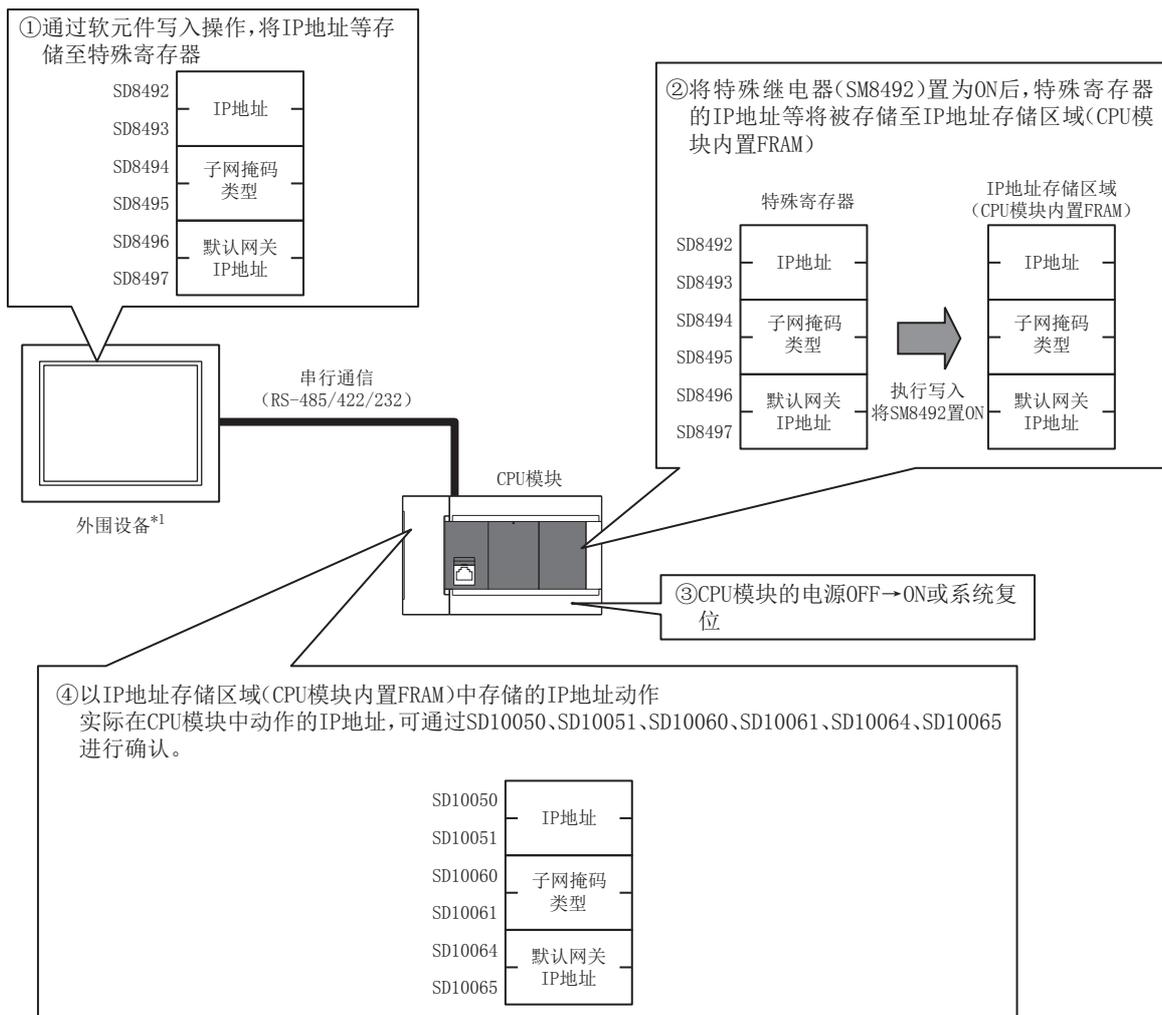
\*1 除了外围设备之外，通过链接功能或MX Component、MX Sheet更改特殊软元件的值，也可以使用IP地址更改功能。关于链接功能的详情，请参照 MELSEC iQ-F FX5用户手册(串行通信篇)。关于MX Component、MX Sheet的详情，请参照各产品的手册。
