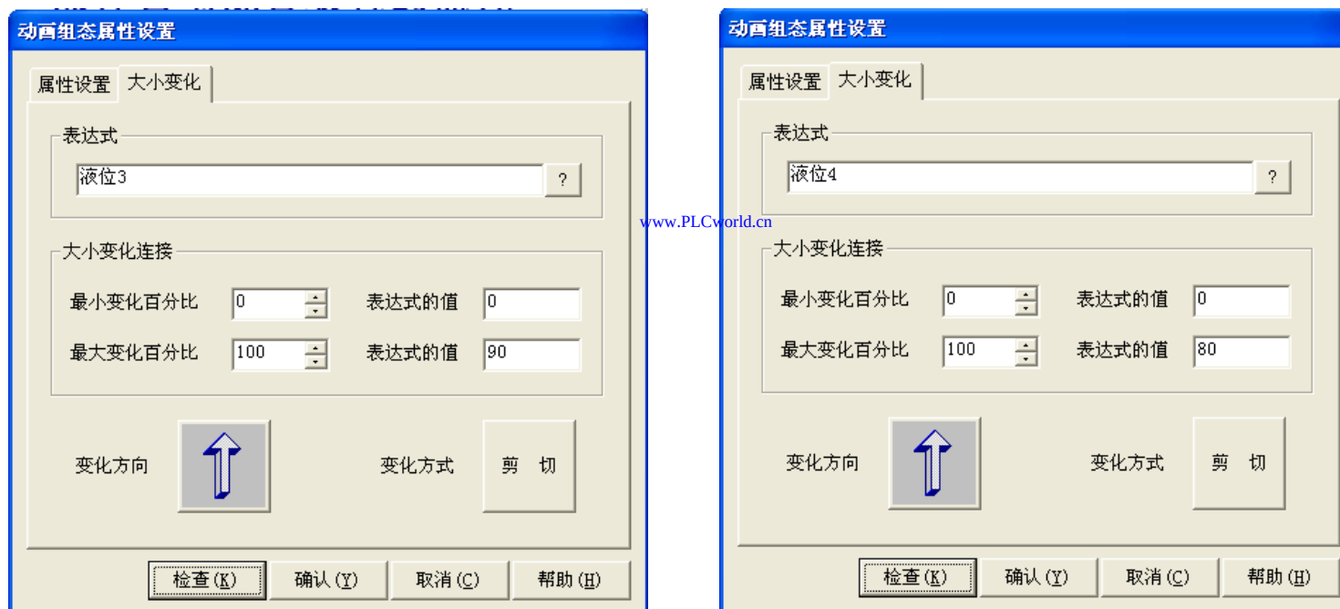
图实训6-14 其他水罐变量的属性设置
