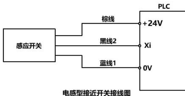
电感型接近开关接线图
