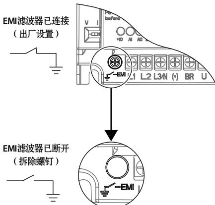
如在变频器进线侧有安装漏电流保护开关 (ELCB/RCD)，断开内置 EMI 滤波器可防止 ELCB/RCD 误动作。
