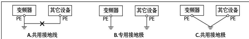
如果同时使用几台变频器，可采取专用接地极或共用接地极方式接地。
